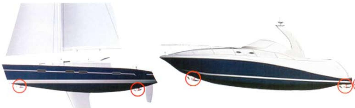
Estos objetivos se cumplen en la propuesta de Exturn: la forma de bulbo de la carcasa en que se monta el propulsor y la hélice minimiza las resistencias hidrodinámicas; su tamaño compacto permite instalarlo en cualquier posición del casco, ya sea en un barco a vela o a motor, y sea cual sea el tamaño.
